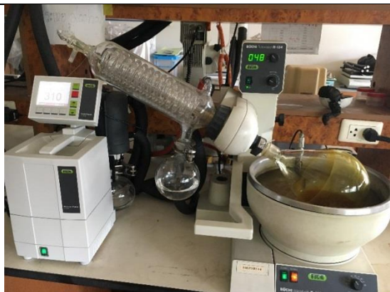
ระเหยตัวทำละลายออกด้วยเครื่อง Rotary evaporator
